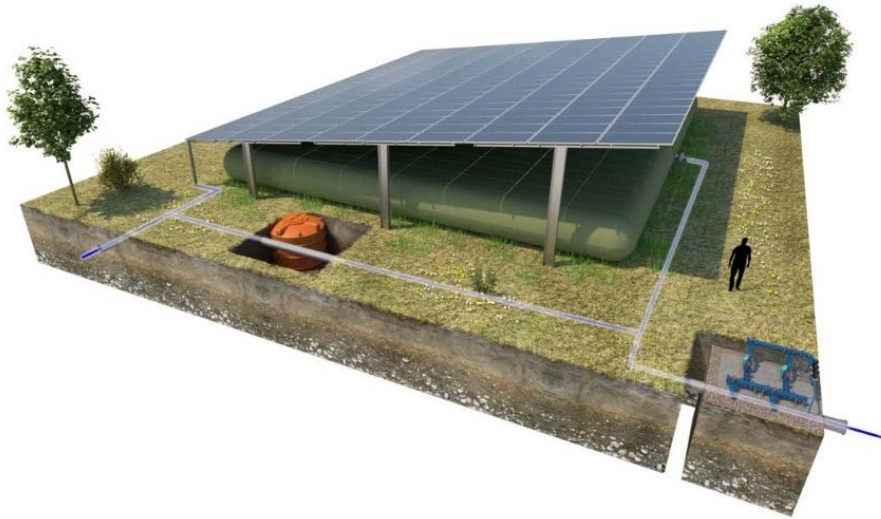
Citernes pour l'irrigation (Source : Akuo)
